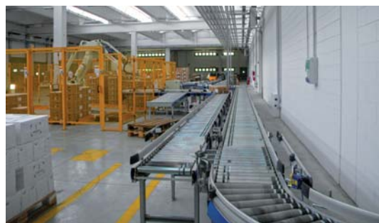
La palletizzazione è effettuata manualmente nel caso dell'ultimo collo di un ordine a cui viene associata la stampa del documento di trasporto, la packing list e un questionario sul servizio ricevuto destinato al cliente, oppure in automatico tramite robot antropomorfo per i colli dal primo al penultimo di ciascun ordine
